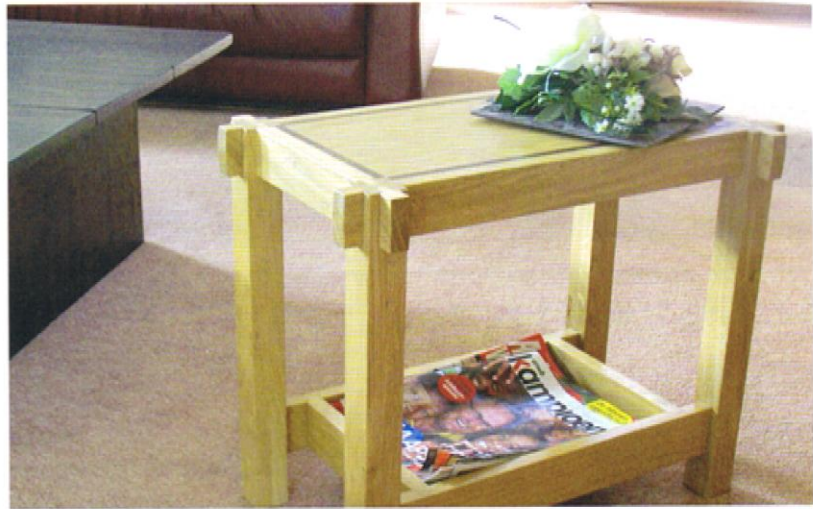
Bij de regionale voorselectie gaf Gerard van den Brink het verplichte tafeltje verjongde poten en koos voor speciale pengatverbindingen onder een hoek
