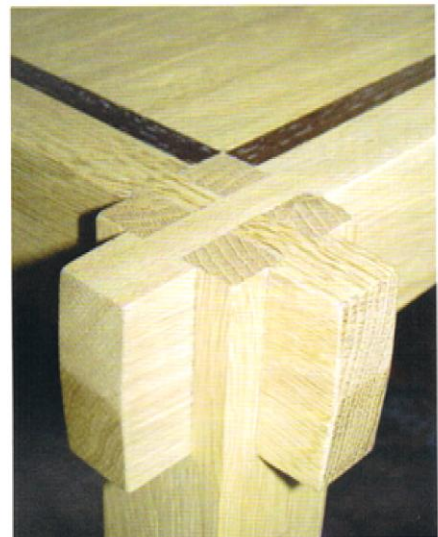
Bij de regionale voorselectie gaf Gerard van den Brink het verplichte tafeltje verjongde poten en koos voor speciale pengatverbindingen onder een hoek
